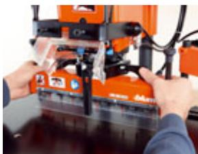
Se puede utilizar un cabezal portabrocas de 9 husillos para taladrado en línea en módulos de 32 mm, así como un cabezal portabrocas de 8 husillos para el montaje de frentes de mueble.
