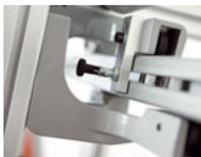
Los topes para ajustar el ancho y la altura de las traseras de mueble se pueden prefijar rápida y fácilmente.
