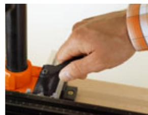
La distancia del taladrado se fija con exactitud mediante una palanca de sujeción.
