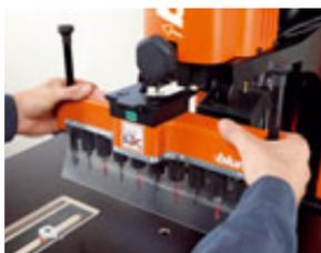
El cabezal portabrocas equipado, identificado también mediante un código de color, se emplea y se ajusta sin herramientas.
