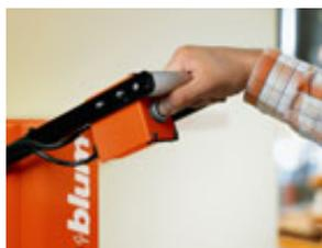
Para realizar un taladrado preciso hay que mover la palanca manualmente hacia abajo.
