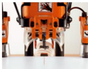
La marcación mediante láser de los topes centrales aumenta la precisión del montaje.
