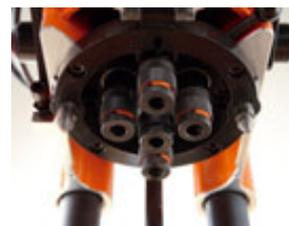
Los mandriles de sujeción rápida permiten cambiar la broca rápida y cómodamente y se pueden instalar posteriormente sin problemas.
