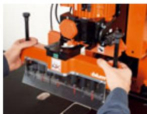
El cabezal portabrocas equipado, identificado también mediante un código de color, se emplea y se ajusta sin herramientas mediante un mando tensor.
