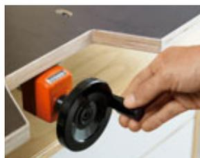
La distancia del taladrado se ajusta con exactitud en la pantalla digital mediante un husillo.
